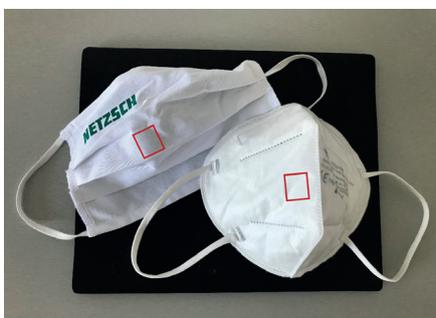
1 | Verwendete Stoff- bzw. FFP2-Maske für die Probenpräparation. Das rote Viereck kennzeichnet die jeweiligen Entnahmestellen.
