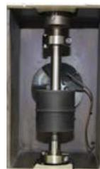
2 Montierter Gummi-Metall-Puffer mit einem Stehbolzen und zwei Gewindebohrungen
