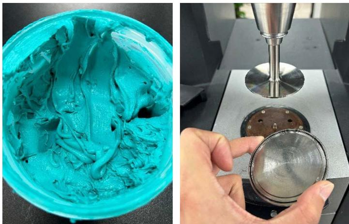
**1** Wärmeleitpaste (links) und PU 60-mm-Geometrie (schnell lösbar, rechts)
