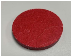
1 GHFM-Proben (Durchmesser: 50 mm), ausgeschnitten aus einer größeren HFM-Platte mit sichtbarer Glasfaserverstärkung.
