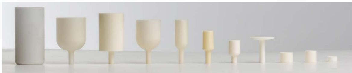
5  $\text{Al}_2\text{O}_3$ -Tiegel mit Volumina von 85  $\mu\text{l}$  bis zu 10 ml
