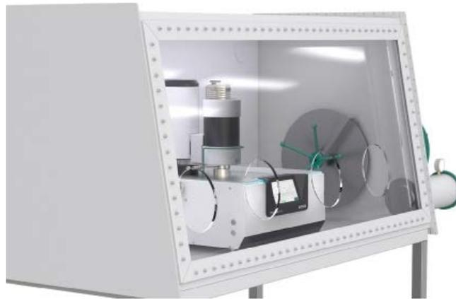
1 Eine NETZSCH STA in einer Glovebox
