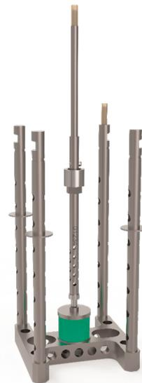
2 Schematische Position einer Druckprobe zwischen Fühlstempel und Probenhalter für die Messung im Kompressionsmodus.
