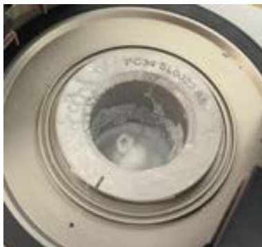
3 Probenvorbereitung des PVA-Hydrogel-Blocks in einem 34-mm Becher
