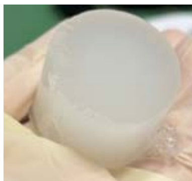
3 Probenvorbereitung des PVA-Hydrogel-Blocks in einem 34-mm Becher
