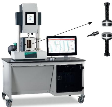
1 DMA GABO EPLEXOR® (Gerät) mit speziellen Sensoren für dielektrische dynamisch-mechanische Messungen
