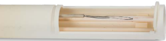
Rohrprobenhaltersystem aus Aluminiumoxid für das Doppel-Messsystem
