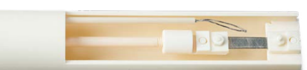
Zugprobenhaltersystem aus Aluminiumoxid
