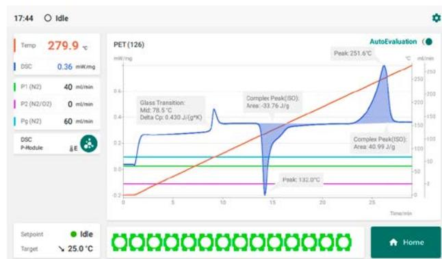
Bei Verwendung von *AutoEvaluation* erfolgt die Auswertung selbsttätig. Die Auswertung nach der Messung ist auf dem Display verfügbar.
