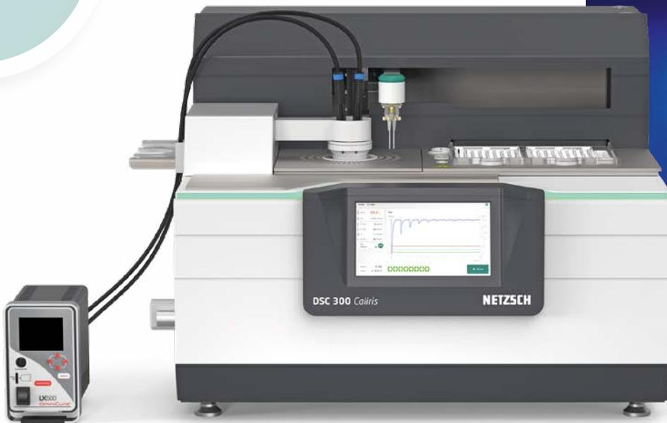
DSC 300 Caliris® mit installiertem UV-Aushärtegerät
