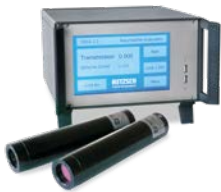
TRDA – Rauchdichte Messgerät mit Lichtmessstrecke
