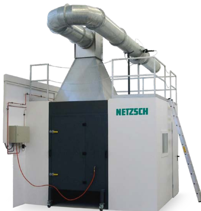
SBI 915 – Brandprüfeinrichtung für Bauprodukte
