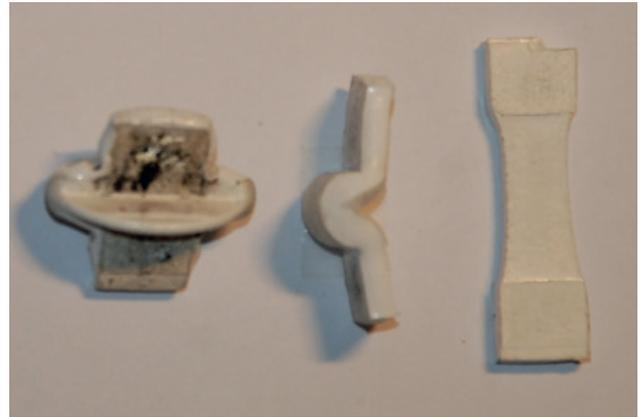
3 Die Amplitude der Anpresskraft ist ausschlaggebend, dass der Probekörper eine plane Form beibehält (links: 0,5 N, Mitte: 0,75 N; rechts: 1 N;  $\pm 0,5$  N)
