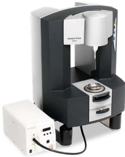
Kinexus Prime ultra+, ausgestattet mit UV-Aushärtungssystem (KNX5007). Der abgebildete System-Stand zum Höherstellen des Kinexus ist nicht in der UV-Zelle KNX5007 enthalten und kann separat bestellt werden (KNW5010).
