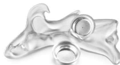
Al crucible with laser-cut Al lid
