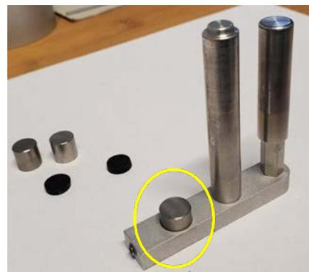
2 Foto der Probenaufbauhilfe, bei dem der Stahlzylinder in die Vertiefung (gelbe Ellipse) eingesetzt wird und mit der Madenschraube festgezogen wurde.
