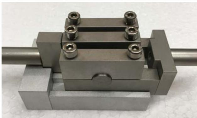
3 Fertig aufgebauter Probenhalter mit eingesetztem Stahlzylinder mit Hilfe der Ausrichtehilfe
